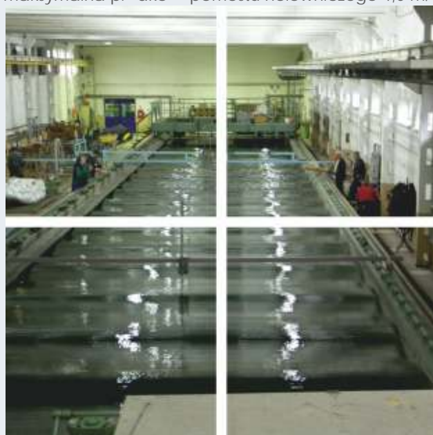
POMOCNICZY BASEN HOLOWNICZY wymiary 60 x 7 x regulowana głębokość 0,0-3,0 m, maksymalna prędkość pomostu holowniczego 4,0 m/s
